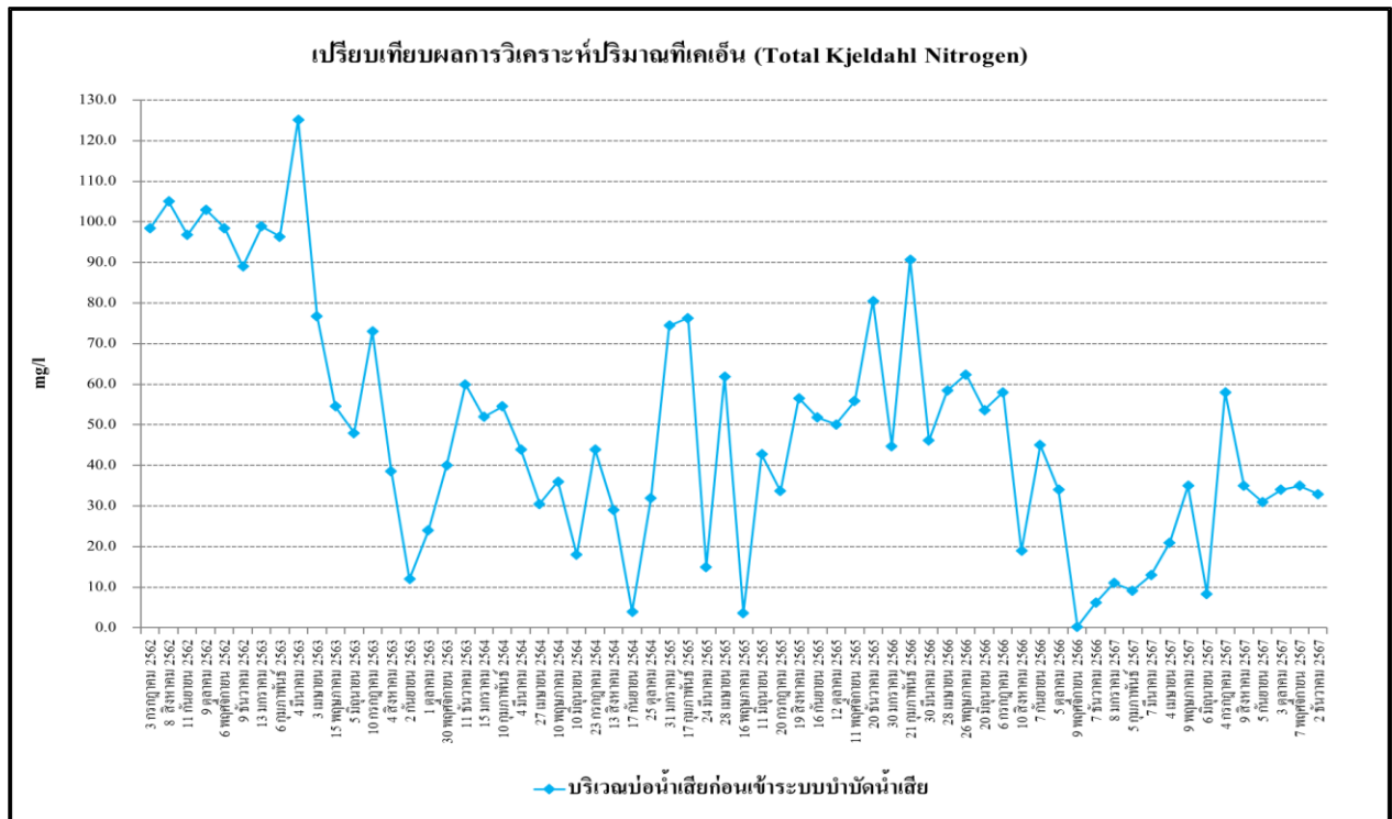
รูปที่ 4.4-26 เปรียบเทียบผลการวิเคราะห์ปริมาณทีเคเอ็น (TKN) บริเวณบ่อน้ำเสียก่อนเข้าระบบบำบัด ระหว่างเดือนกรกฎาคม 2562 - ธันวาคม 2567
