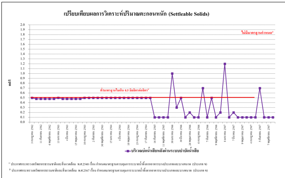
รูปที่ 4.4-33 เปรียบเทียบผลการวิเคราะห์ปริมาณตะกอนหนัก (Settleable Solids) บริเวณบ่อน้ำเสียหลังผ่านระบบบำบัด ระหว่างเดือนกรกฎาคม 2562 - ธันวาคม 2567
