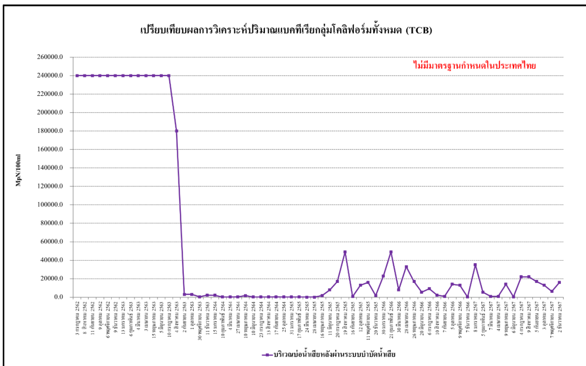
รูปที่ 4.4-37 เปรียบเทียบผลการวิเคราะห์ปริมาณแบคทีเรียกลุ่มโคลิฟอร์มทั้งหมด (TCB) บริเวณบ่อน้ำเสียหลังผ่านระบบบำบัด ระหว่างเดือนกรกฎาคม 2562 - ธันวาคม 2567
