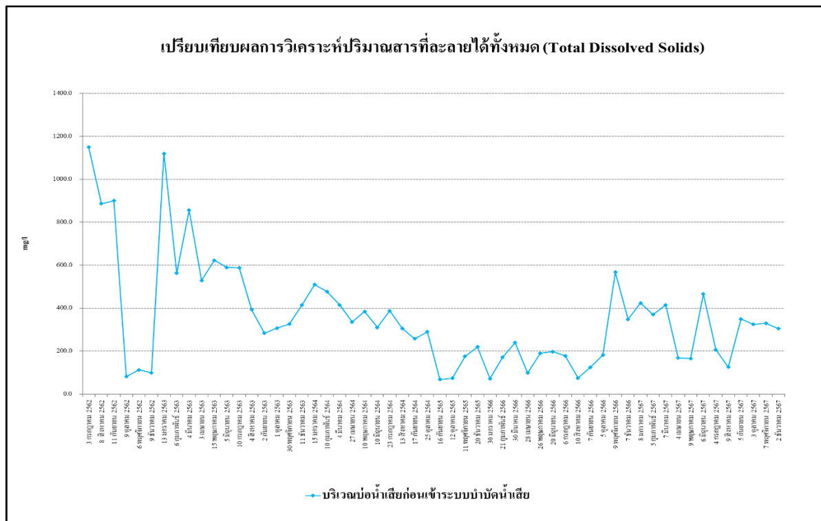
รูปที่ 4.4-23 เปรียบเทียบผลการวิเคราะห์ปริมาณสารที่ละลายได้ทั้งหมด (Total Dissolved Solids) บริเวณบ่อน้ำเสียก่อนเข้าระบบบำบัด ระหว่างเดือนกรกฎาคม 2562 - ธันวาคม 2567
